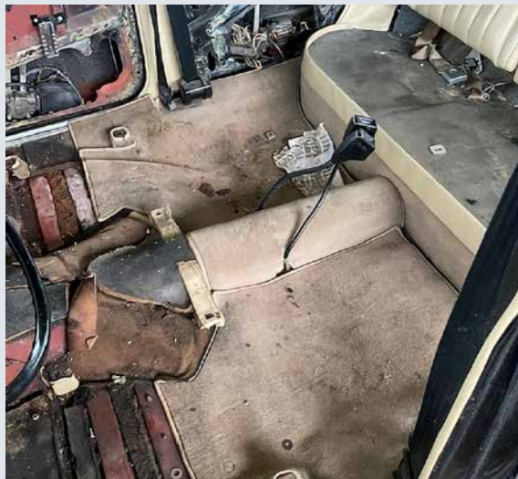
So sah SRX 1200 dann bei der Abholung in 2021 aus ... es stand ca. 2 cm Wasser drin und Schimmel machte sich auch schon breit ...
