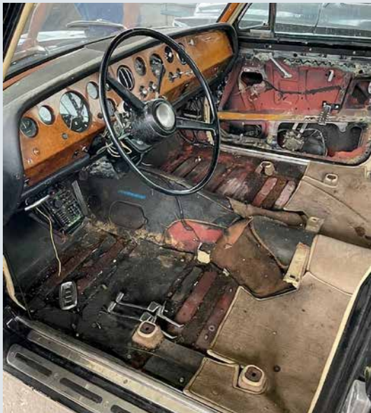
So sah SRX 1200 dann bei der Abholung in 2021 aus ... es stand ca. 2 cm Wasser drin und Schimmel machte sich auch schon breit ...
