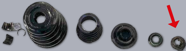
Mit Pfeil markiert, die alte verschlissene Filzdichtung
