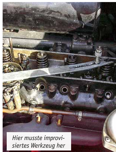
Man beachte den Metallstab im Kerzenloch, er verhindert ein Eintauchen des Ventils in den Brennraum
