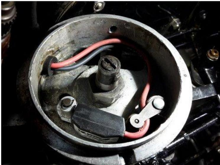
Verteiler mit eingesetztem Hall-Geber für elektr. Unterbrechung - der Kondensator wird nicht mehr benötigt, der spezielle Verteilerfinger ist abgenommen
