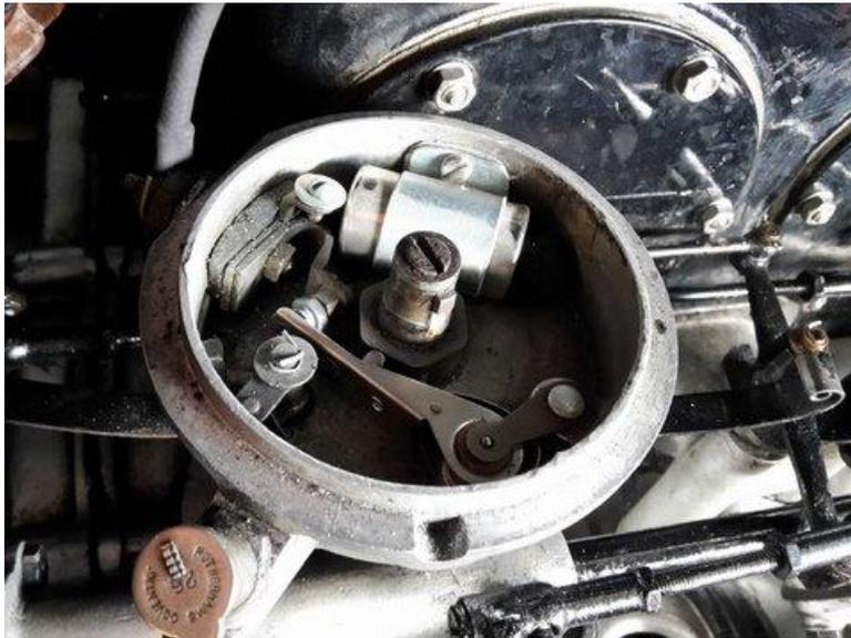
Verteiler mit konventionellem Unterbrecherkontakt mit abgenommenem Verteilerfinger- im Hintergrund der kleine runde sehr wichtige Kondensator- er sollte 27-32 uFard haben ( Ph II)
