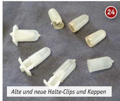
Halte-Clip mit Kappe im Schweller
