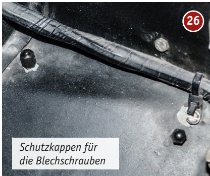
Halte-Clip mit Kappe im Schweller
