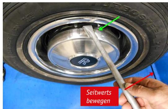
Wer nun selbst einmal, auf diese Weise, die Raddeckel seines Rolls-Royce oder Bentleys demontiert hat wird schnell merken, dass man gut daran tut die Raddeckel mit einer Hand festzuhalten, denn mit der 12 Uhr/1 Uhr Methode lösen sich die Raddeckel mit einem kurzen, knackigen Plop von der Felge und verkratzen schnell wenn man sie nicht festhält.
