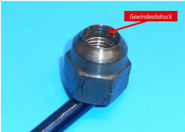
Wird nun eine Linksgewinde Mutter beim Versuch sie zu lösen fälschlicherweise angezogen, wird die Innenflanke des Mutterkonus in den Radbolzen gedrückt und die Mutter kann dann kaum noch gelöst werden. Hat man die Mutter dann doch noch vom Bolzen gedreht kann man ganz klar die Gewindeabdrücke erkennen. Diese Muttern müssen dann innen mechanisch bearbeitet werden, damit sie weiter verwendet werden können.
