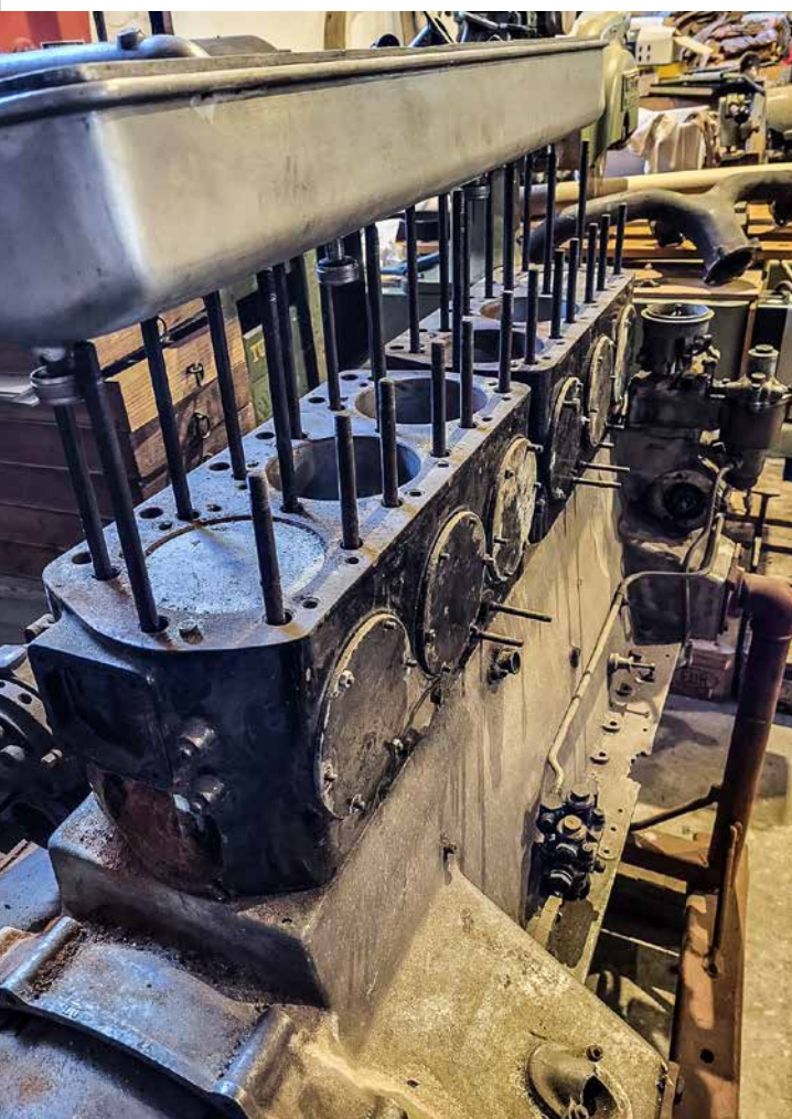
Die letzten Überbleibsel des einst stolzen Phantom II: Der amateurhaft auseinandergebaute Motor LU45.
