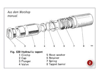
Kolben (Plunger), der sich in dem Zylinder, durch eine Feder nach oben gedrückt, geringfügig auf und ab bewegen kann, dann aus zwei Öl-Kammern, die über ein Rückschlagventil miteinander verbunden sind, und aus kleinen Öl-Bohrungen. (Abb. 2 aus dem Worshop manual; Abb. 3 eigener zerlegter Stößel; Abb. 4 modifiziert nach `The Autocar`)
