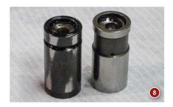
gen ist in den "neuen' Stößeln ein klassisches Kugelventil mit kleiner Spiralfeder vorhanden, während die Originale flache Tellerventile mit Wave washer/ Federring aufweisen. Die kleine Öl-Bohrung, die ins Innere führt, ist auf beiden Tappets zu erkennen.
