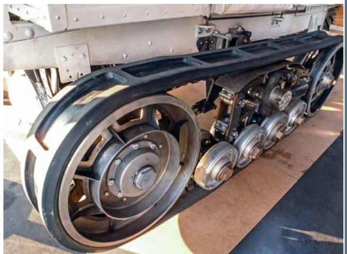
Hinsichtlich Traktion in schwierigem Gelände ist ein Halbketten-Antrieb kaum zu schlagen.
