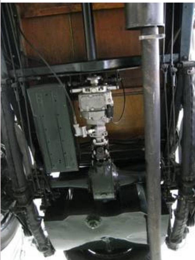
**Bild 7 - der Overdrive direkt vor dem Hinterachsdifferential mit Tachowelle und Schaltkabel**
