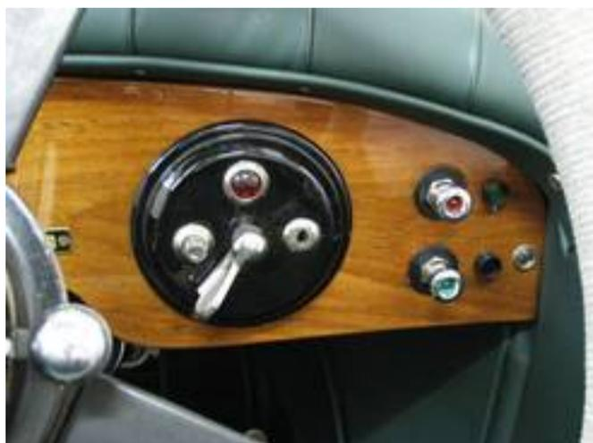
**Bild 8 - die 2 Zugschalter rechts neben dem Zündschloss- oben Warnblinker (rot), darunter Oberdrive (grün)**
