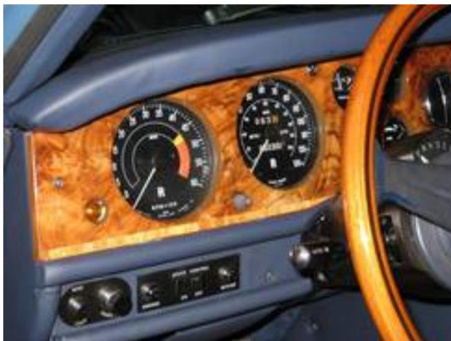
**Bild 3 - Drehzahlmesser in der Rolls-Royce Corniche, Baujahr 1975**
