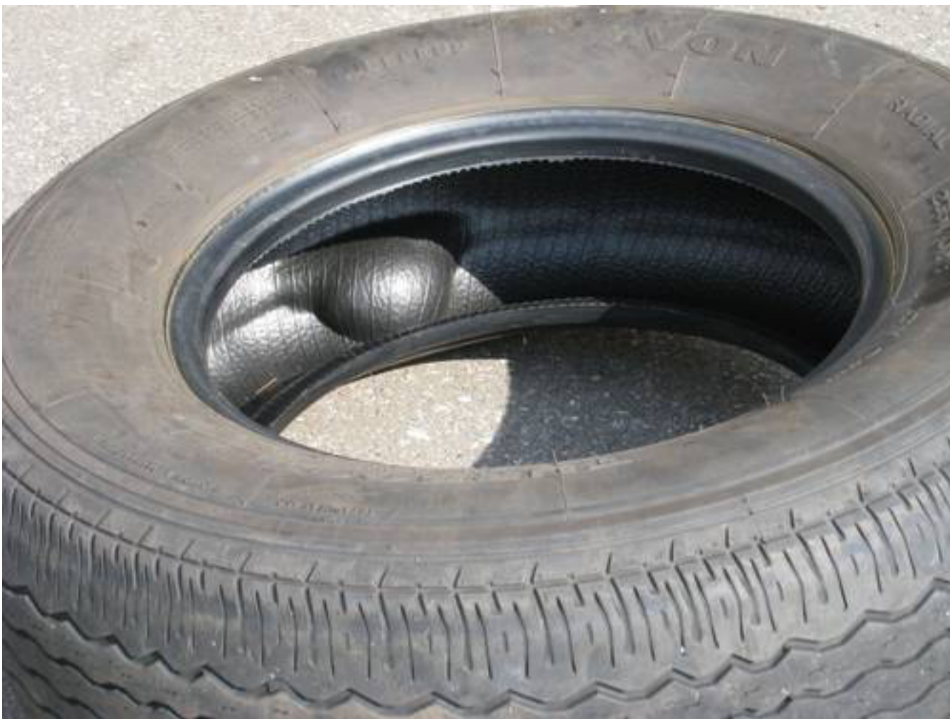
Bild Nr. 2: Der Bruch in der Karkasse kann aber auch zu einer Beule nach innen führen.
