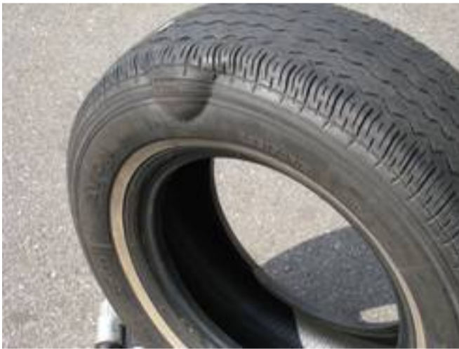
Bild Nr. 1: Ausbuchtung in der Seitenwand in Folge eines Bruchs in der Karkasse.
