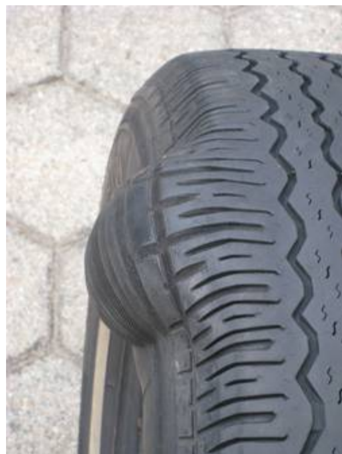
Bild Nr. 4: Neben der Beule in der Seitenwand kann man sehr gut die feinen Risse der Versprödung erkennen.
