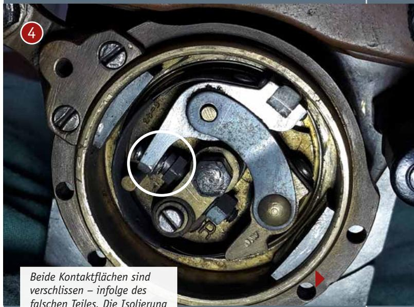
Beide Kontaktflächen sind verschlissen – infolge des falschen Teiles. Die Isolierung der Feder gehört entfernt!
