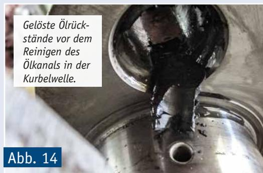
Gelöste Ölrückstände vor dem Reinigen des Ölkanals in der Kurbelwelle.
