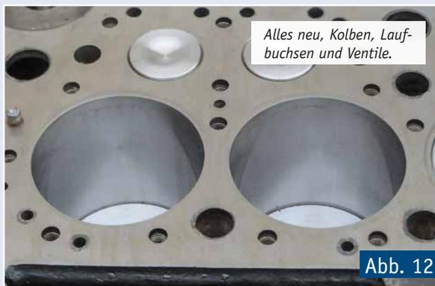
Alles neu, Kolben, Laufbuchsen und Ventile.
