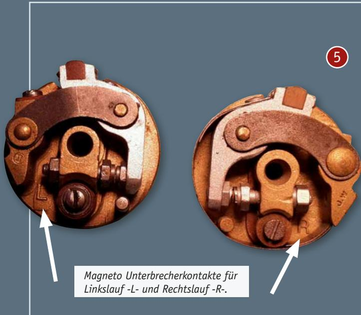
Magneto Unterbrecherkontakte für Linkslauf -L- und Rechtslauf -R-.
