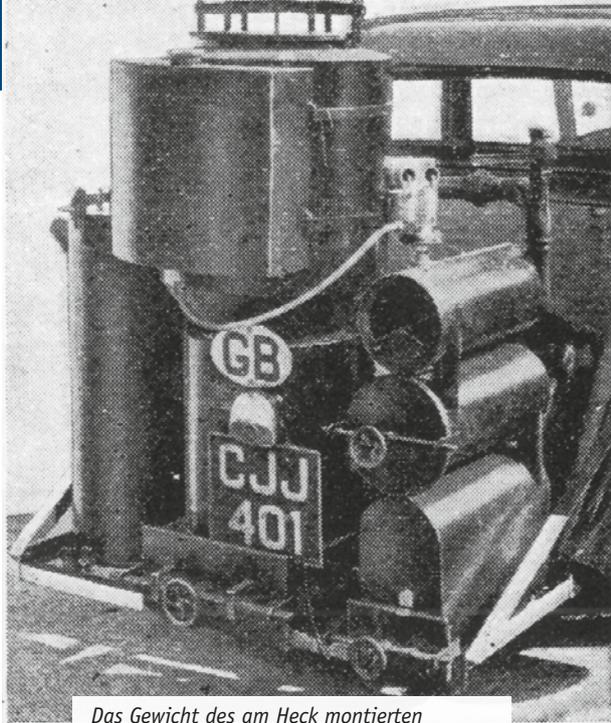
*Das Gewicht des am Heck montierten Holzgas-Generators wirkte sich auf das Fahrverhalten und die Brems-Eigenschaften aus.*
