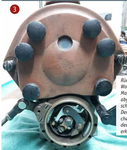
Rückseite des Watford Typ E06 Magnetos mit abgenommener schwarzer Kappe. Der Unterbrecherkontakt ist deutlich zu erkennen.
